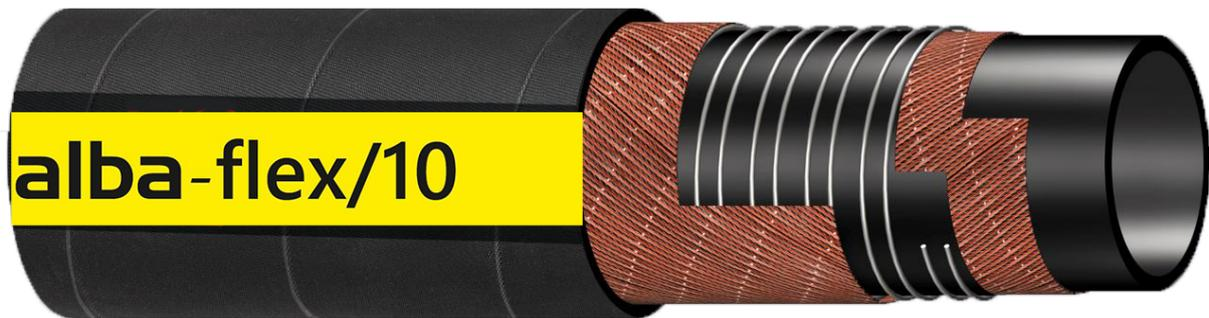
Mehrzweckschlauch zum Absaugen und Fördern von heißem Wasser, Meerwasser, neutraler Säure und basischen Lösungen, Farben auf Wasserbasis, Ketonen und esternhaltigen Lösungsmitteln.
